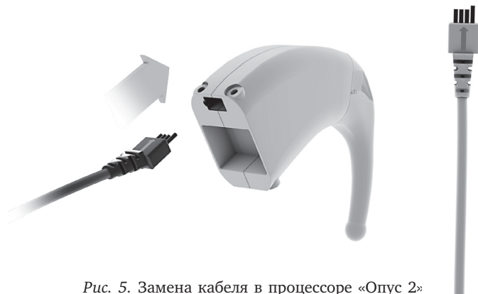
Рис. 5. Замена кабеля в процессоре «Опус 2»
